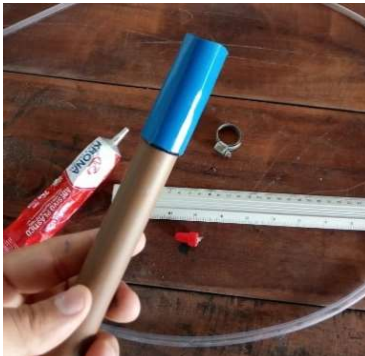
Figura 16: Mangueira flexível da tomada de pressão após a colagem.
