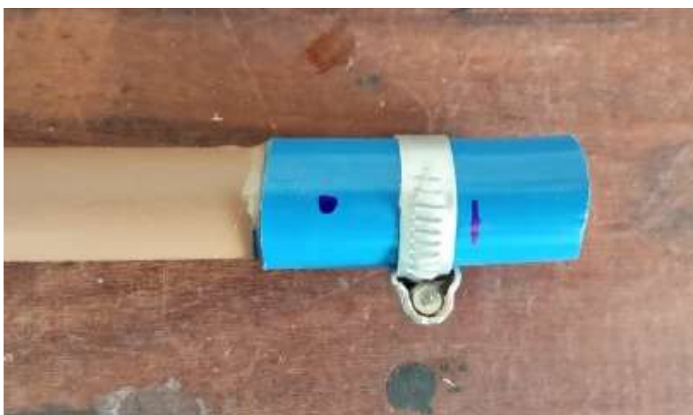
Figura 17: Braçadeira metálica fixada à tomada de pressão.
