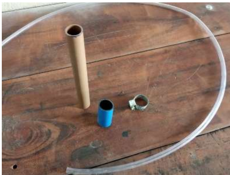
Figura 14: Materiais utilizados para construção das tomadas de pressão.
