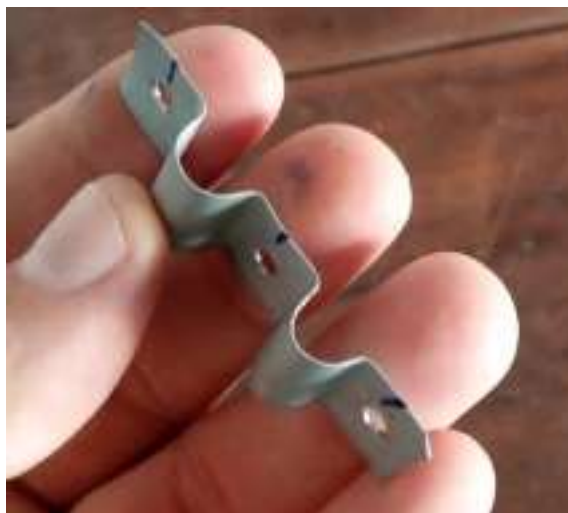
Figura 25: Braçadeira para fixação das mangueiras piezométricas.
