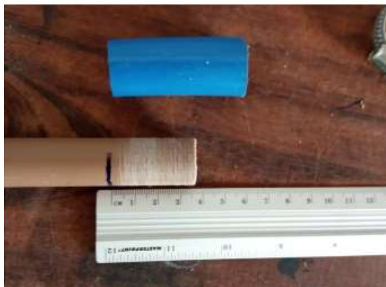
Figura 15: Extremidade da tomada de pressão preparada para colagem.
