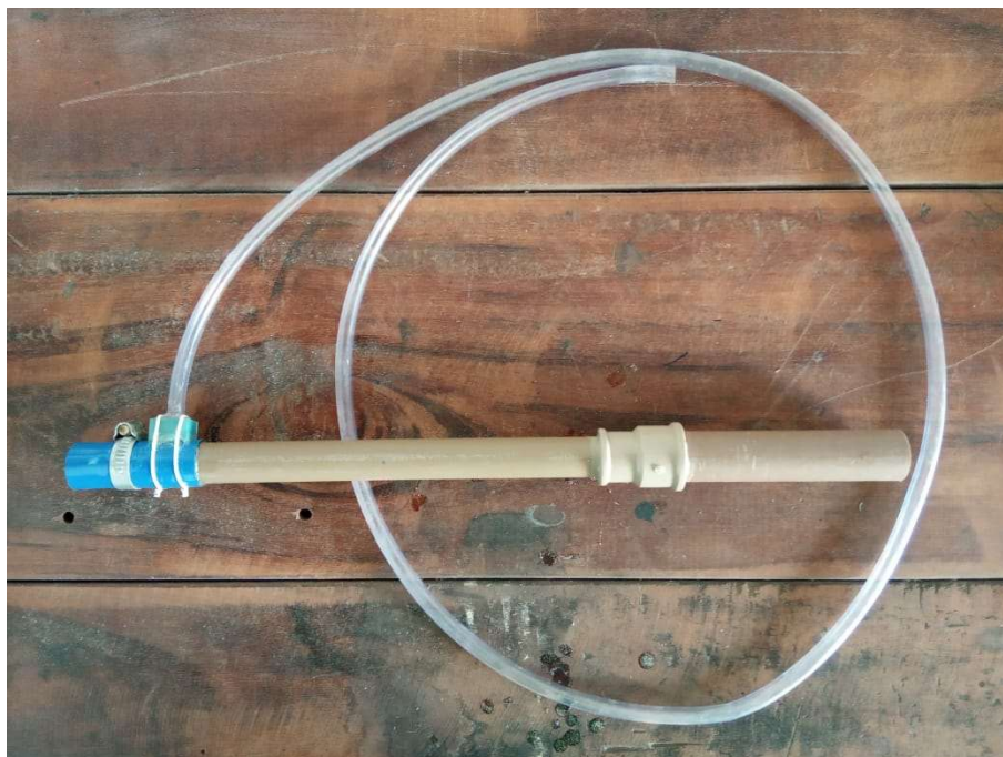
Figura 23: Tubulação para entrada de água no aparato.
