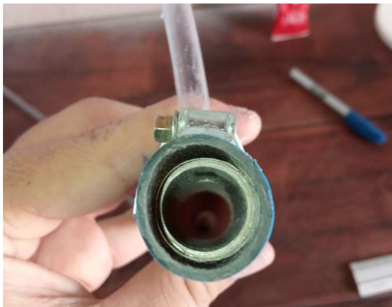
Figura 22: Detalhe do interior da tubulação após cortar o excesso de mangueira e lixar.
