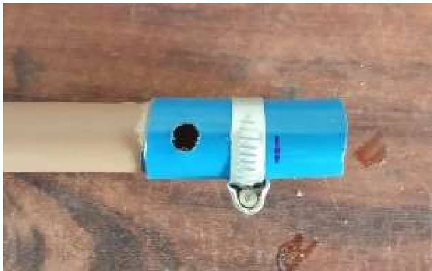
Figura 18: Detalhe do furo feito para encaixar a mangueira piezométrica.
