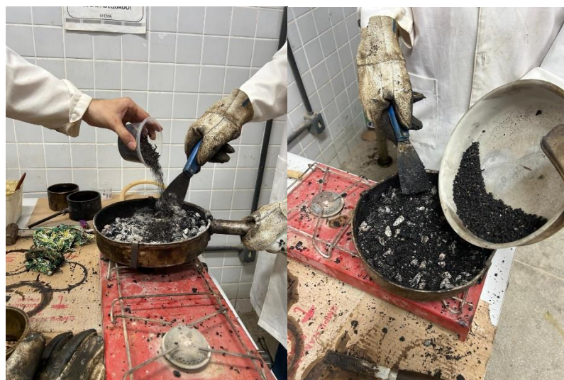
Figura 18: Mistura do corpo de prova com adição do RAP a frio e quente.
