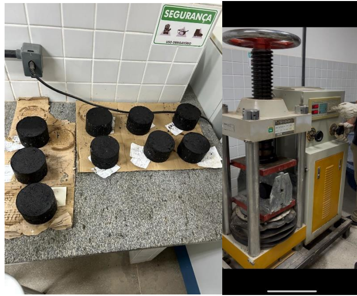
Figura 20: Corpos de provas e ensaio de resistência a tração por compressão diametral.
