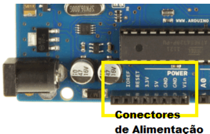
Figura 13 - Pinos de alimentação da placa
