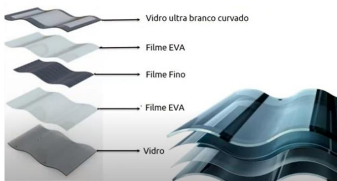
Figura 9 - Estrutura da telha HW MQSB V230
