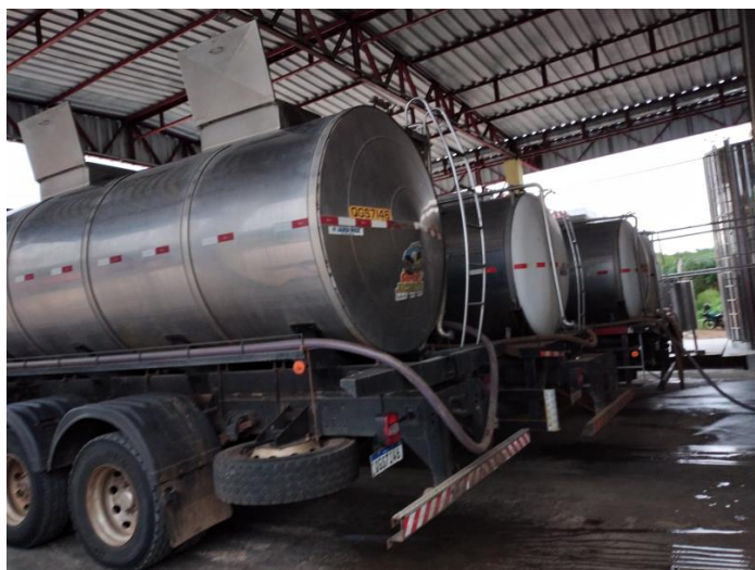
Figura 2-Caminhão isotérmico de 12.000 litros
