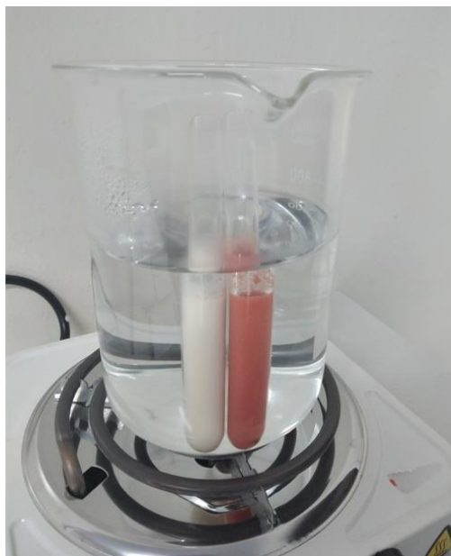
Figura 18 - A esquerda teste negativo, a direita teste positivo para sacarose
