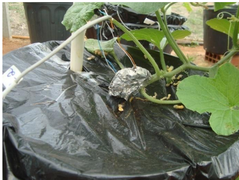
Figura 7. Isolamento térmico após instalação dos sensores, com o uso de papel alumínio, Mossoró – RN, 2013.
