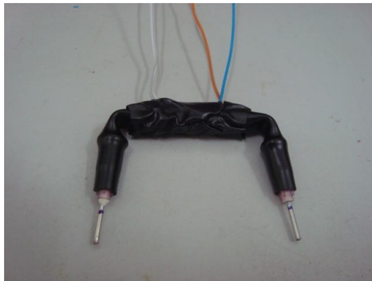
Figura9. Sensor de fluxo de seiva por dissipação térmica (SFSD), Mossoró – RN, 2013.
