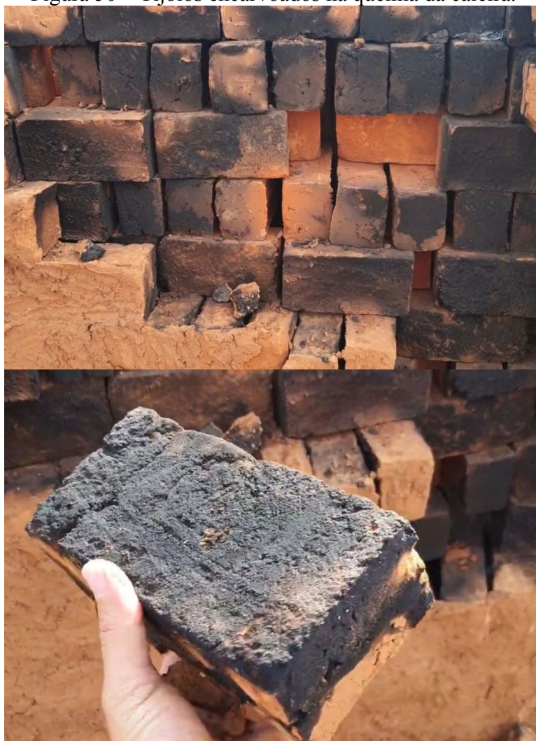
Figura 50 – Tijolos encarvoados na queima da caieira.
