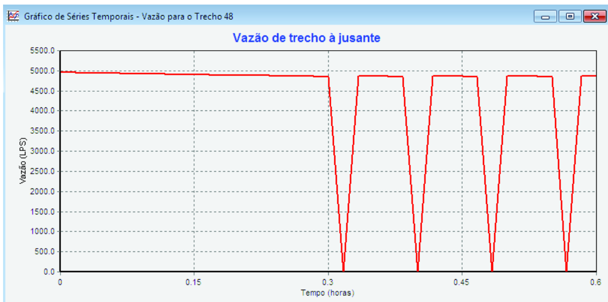
Figura 35 – Vazão de trecho à jusante do Stand-Pipe
