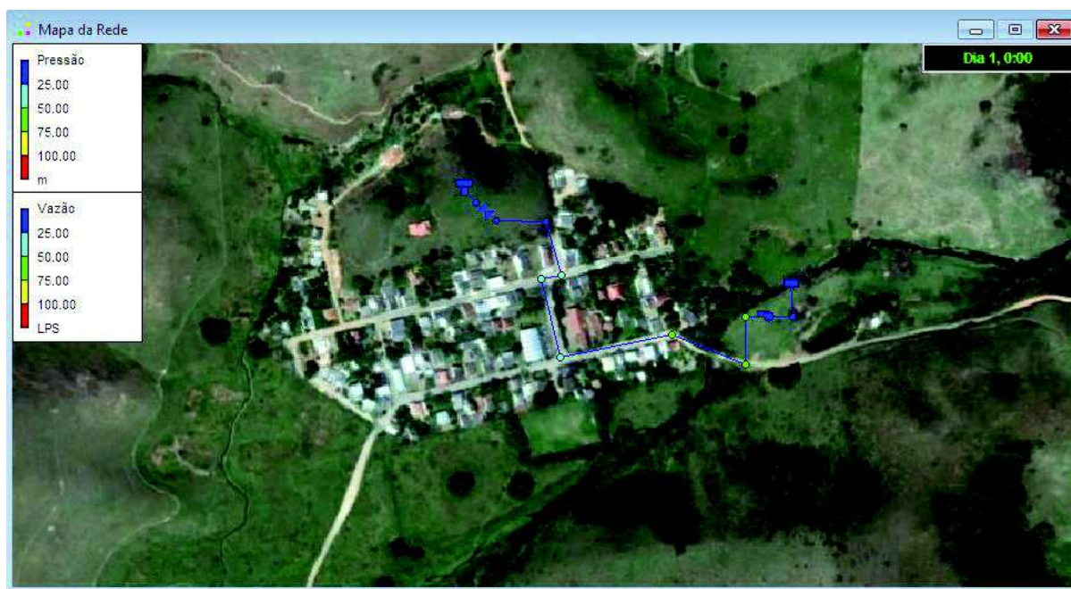
Figura 28 – Sistema de recalque sobre imagem de fundo
