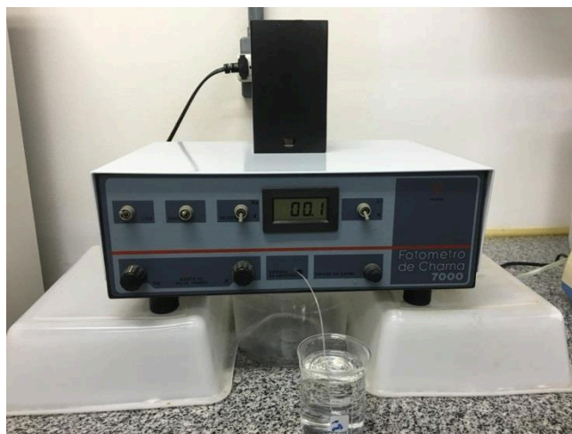
Figura 10 - Fotômetro fazendo a quantificação do potássio.
