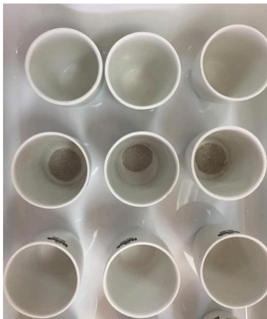
Figura 8 - Cadinhos após os procedimentos com a matéria inorgânica das amostras.
