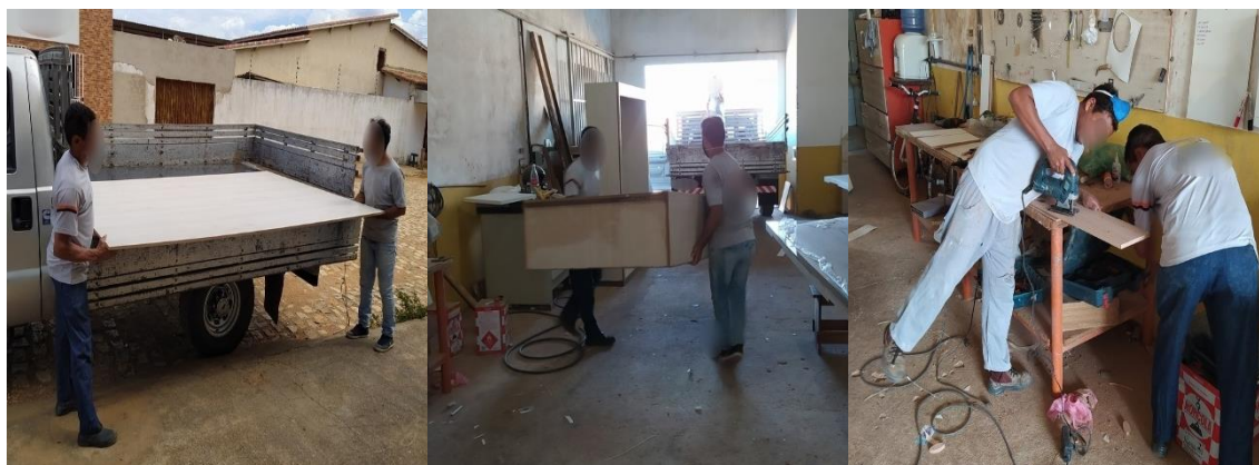
Figura 4. Exposição dos trabalhadores aos agentes ergonômicos tais como: transporte de peso e objeto e posturas inadequadas (fotos da Esquerda para direita). Fonte: Autoria Própria (2020).
