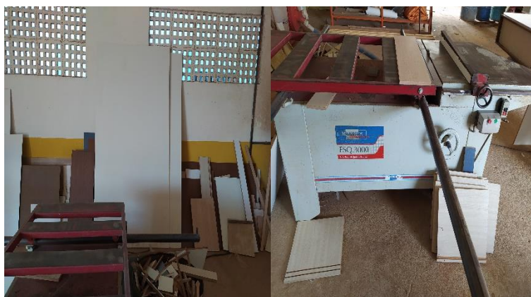
Figura 2. Agentes calor gerada no ambiente, ruídos e vibrações oriundos da esquadrejadeira. (Fotos da esquerda para direita). Fonte: Autoria própria (2020).
