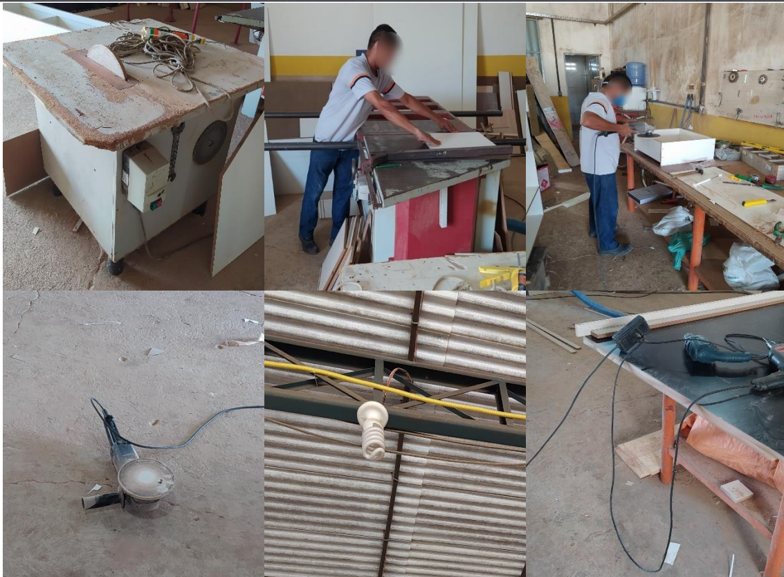
Figura 5. Exposição dos trabalhadores a agentes de acidentes tais como: lixadeira orbital de disco sem proteção; esquadrejadeira sem proteção; lixadeira orbital sem proteção; lixadeira orbital jogada no piso; iluminação defeituosa; utilização de extensões (fotos da Esquerda para direita). Fonte: Autoria Própria (2020).
