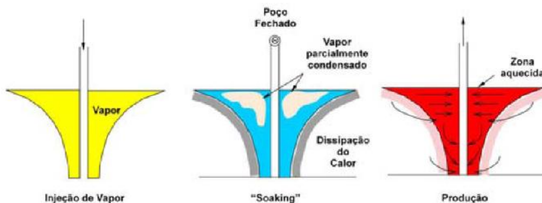
Figura 8. Esquema básico da Injeção Cíclica de Vapor.
