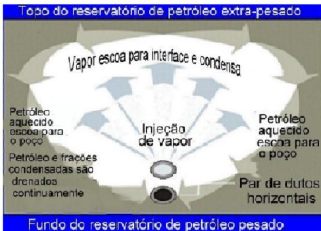
Figura 10. Representação do Fluxo no Injetor.
