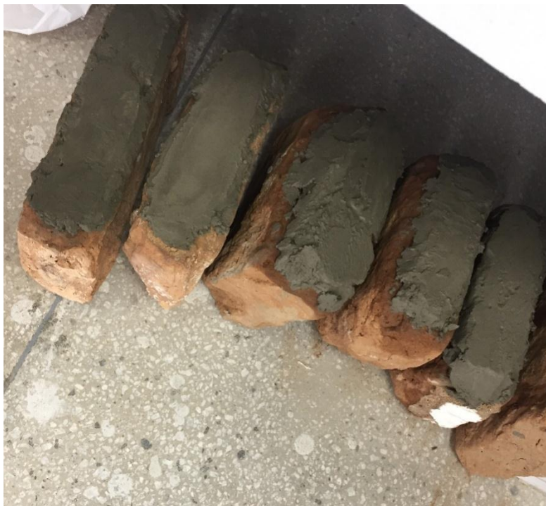
Figura 16 – Capeamento dos blocos
