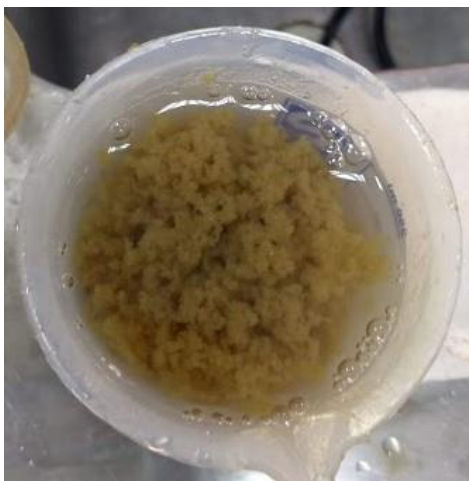
Figura 8: Aparência de lodo floculado com excesso de produto
