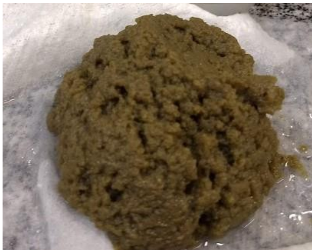
Figura 14: Aparência do lodo com superdosagem
