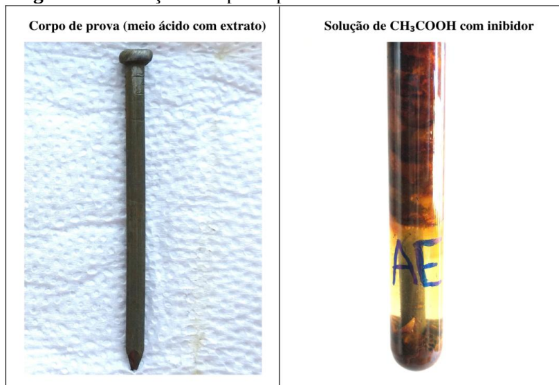
Figura 26 - Solução e corpo de prova em meio ácido com inibidor
