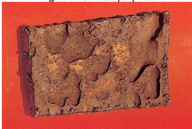
Figura 3 - Corrosão por placas
