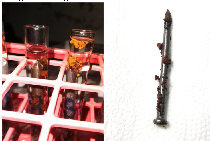
Figura 30 - Prego em meio básico em um dia de imersão
