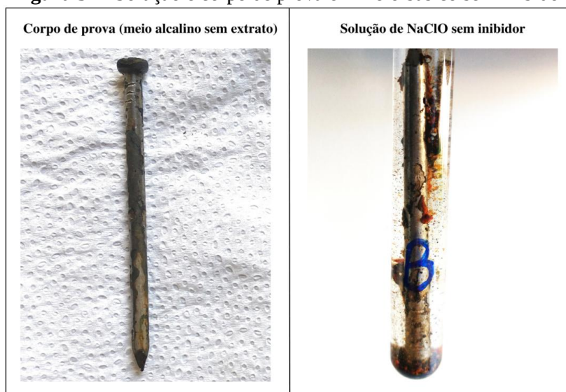
Figura 31 - Solução e corpo de prova em meio básico sem inibidor
