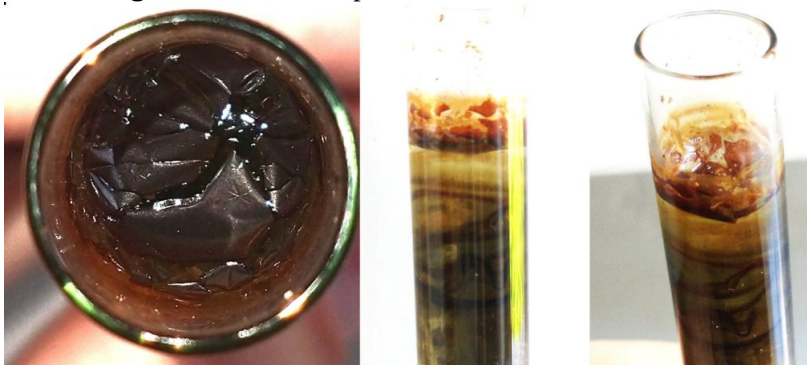
Figura 29 - Camada protetora formada no meio NE
