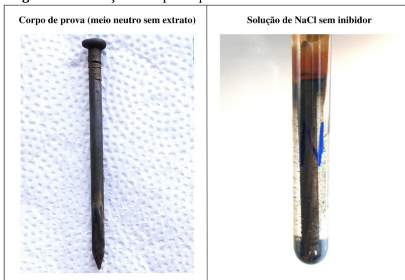
Figura 27 - Solução e corpo de prova em meio neutro sem inibidor
