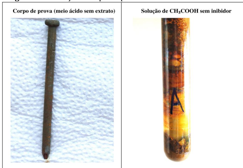
Figura 25 - Solução e corpo de prova em meio ácido sem inibidor
