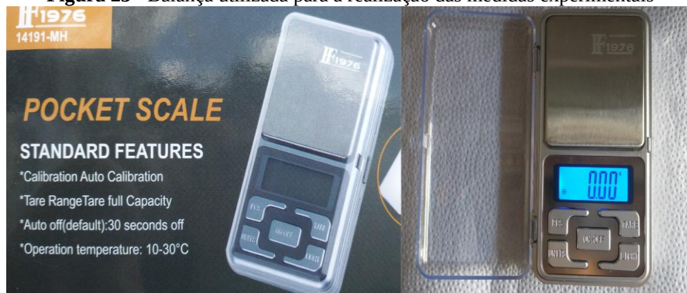
Figura 23 - Balança utilizada para a realização das medidas experimentais
