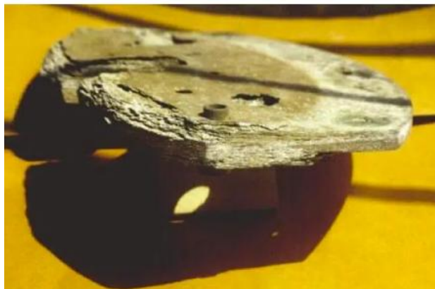
Figura 7 - Corrosão por esfoliação
