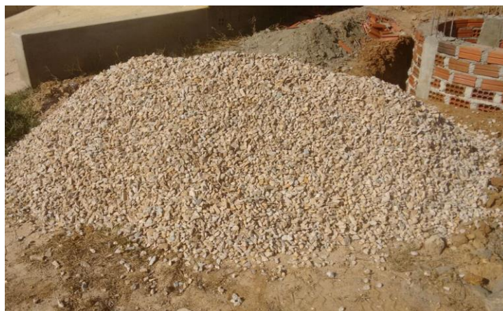
Figura 7: Brita utilizada para a produção dos concretos
