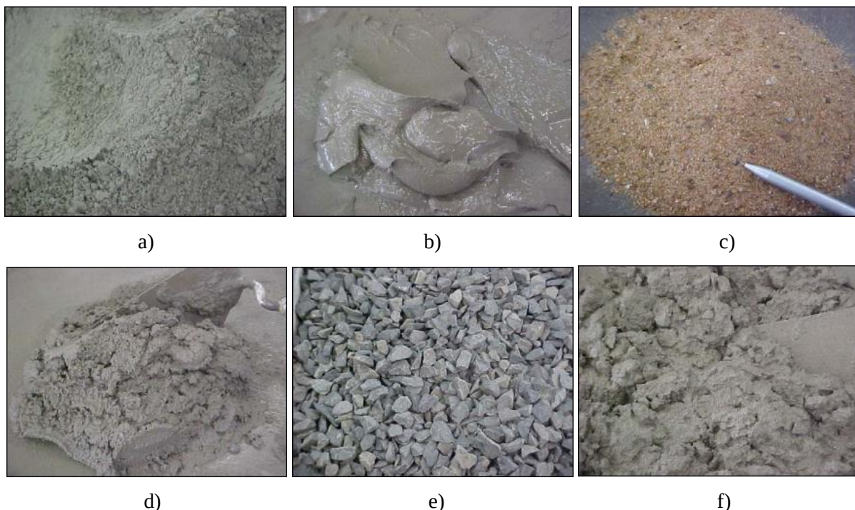
Figura 1: a) Cimento. b) Pasta de cimento e água. c) Agregado miúdo (areia). d) Argamassa. e) Agregado graúdo (pedra ou brita). f) Concreto simples
