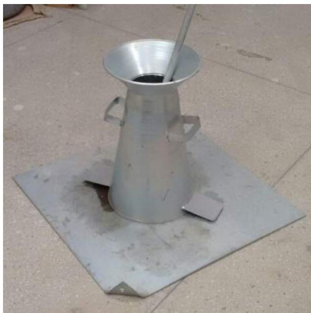
Figura 9: Equipamento utilizado no Slump Test
