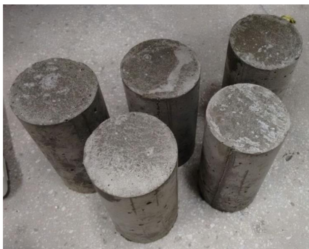
Figura 8: Corpos-de-prova de concreto betonado após a desmoldagem
