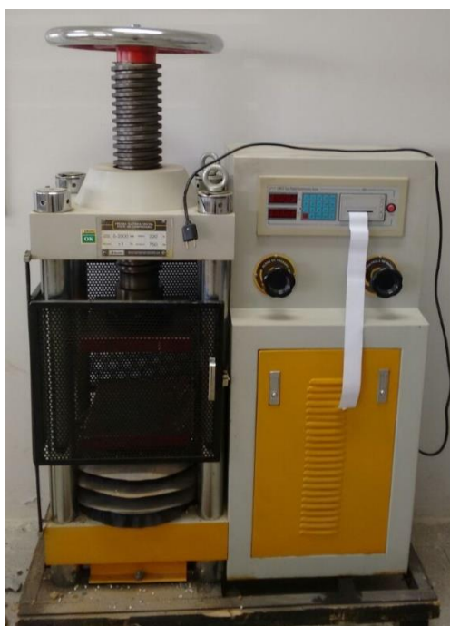
Figura 10: Prensa hidráulica utilizada para o ensaio de resistência à compressão
