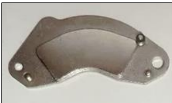
Figura 5. Imã extraído de disco rígido (Autoria própria)
