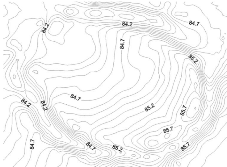
Figura 1 – Representação das curvas de nível de um terreno
