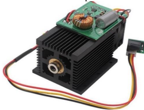
Figura 16 – Módulo com laser pulsado - 15W e 450nm.
