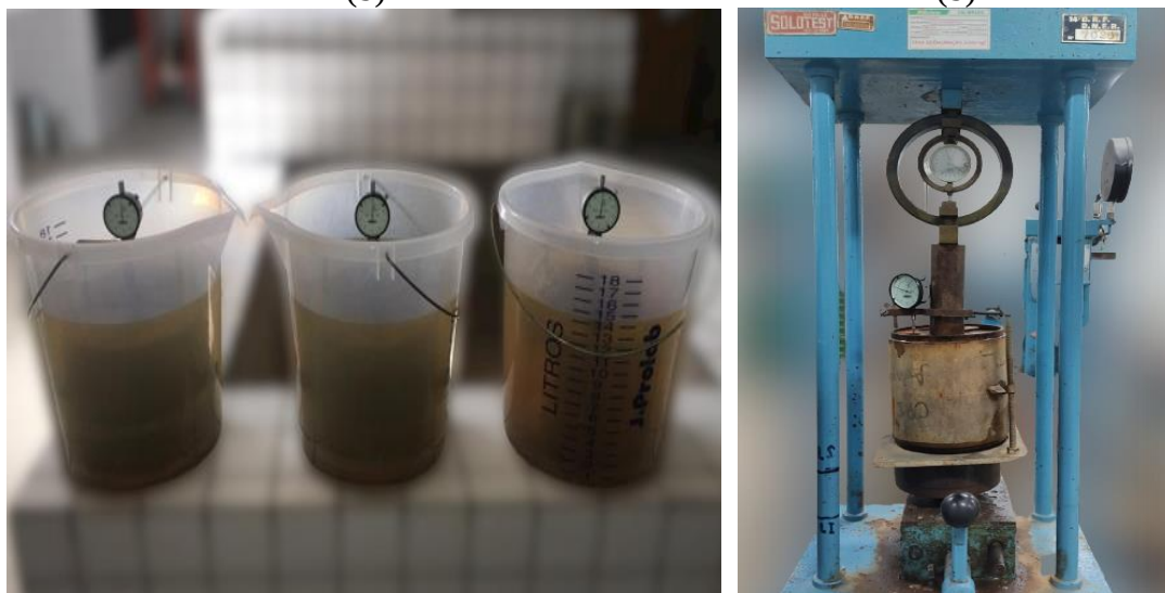
Figuras 20 – Execução do ensaio do Índice de Suporte Califórnia (b)
