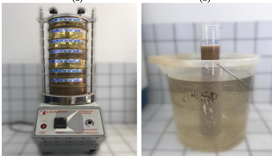
Figuras 17 – Peneiramento grosso (a) e sedimentação do solo regional (b)
