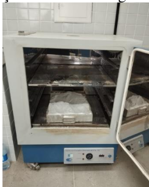
Figura 04 – Disposição do resíduo de gesso triturado em estufa
