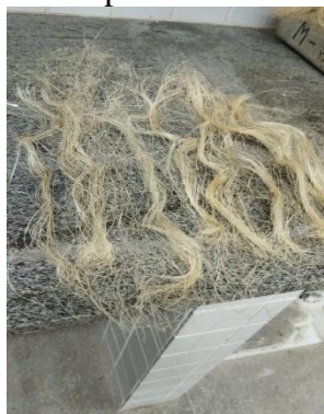
Figura 05 – Fibra de sisal preparada para ser incorporada à TRL
