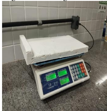
Figura 07 – Demonstração da pesagem da telha de gesso reciclado incorporada com fibra de sisal
