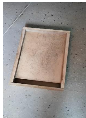
Figura 06– Forma utilizada na fabricação da TRL
