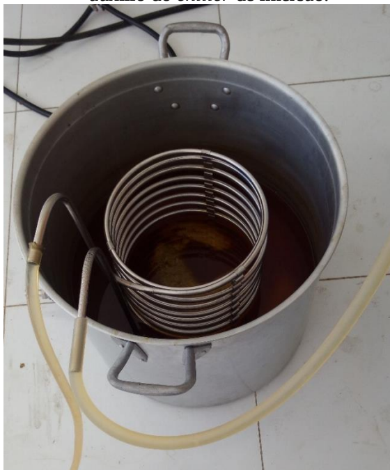
Figura 20 – Resfriamento do mosto com auxílio do chiller de imersão.
