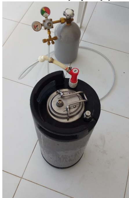
Figura 28 – Carbonatação por injeção de \text{CO}_2
