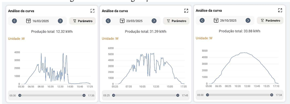
Figura 4: Curvas de geração fotovoltaica medidas.
