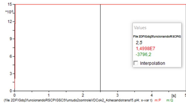
Figura 43 - Dados de simulação para P_S = 15\text{MW} no modo subsíncrono.
