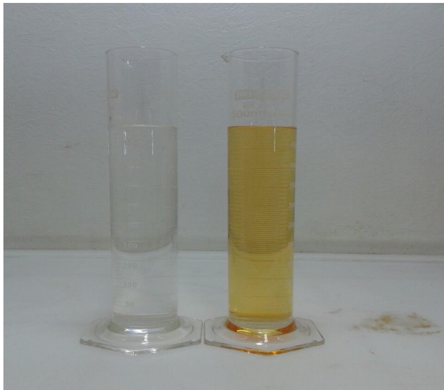
Figura 3 - Ensaio da cor e aspecto das amostras de etanol e gasolina C
