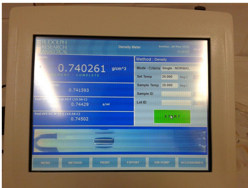
Figura 4 - Equipamento utilizado na determinação da massa específica das amostras
