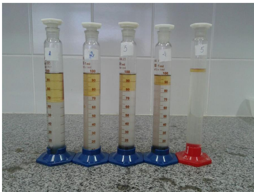
Figura 5 - Ensaio de determinação do teor de etanol anidro combustível nas amostras
