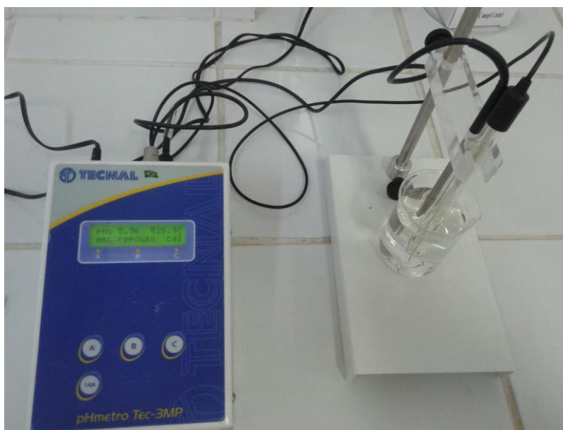
Figura 7 - Equipamento utilizado na determinação do pH das amostras
