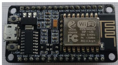
Figura 9. Microcontrolador ESP8266 acoplado à placa de prototipagem NodeMCU v3
