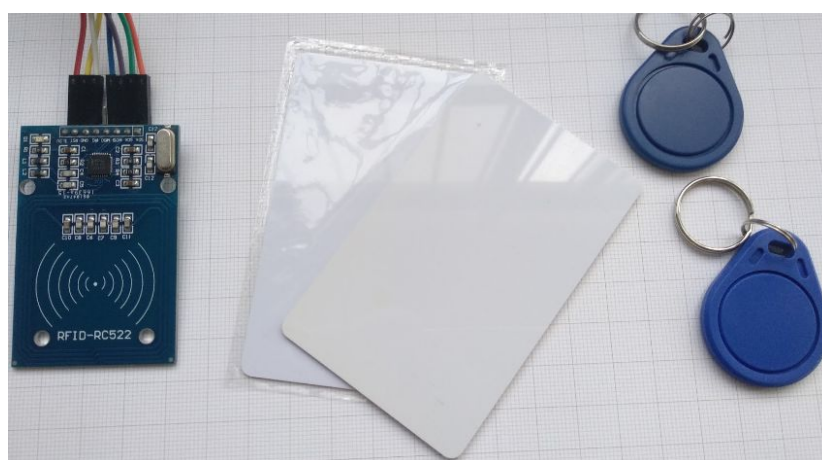
Figura 10. Leitor RFID (MFRC-522); cartões RFID passivos (MIFARE 1KB); chaveiros RFID passivos
