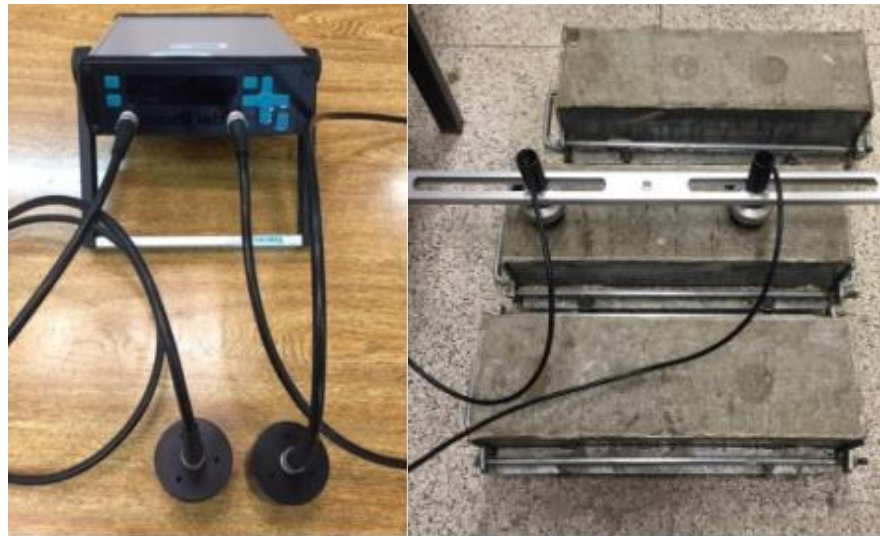
Figura 11 - a) Equipamento de ultrassom. b) Equipamento durante o uso.
