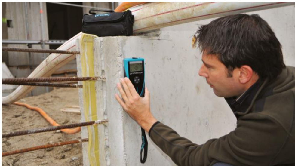
Figura 10 - Operador manuseando o pacômetro.
