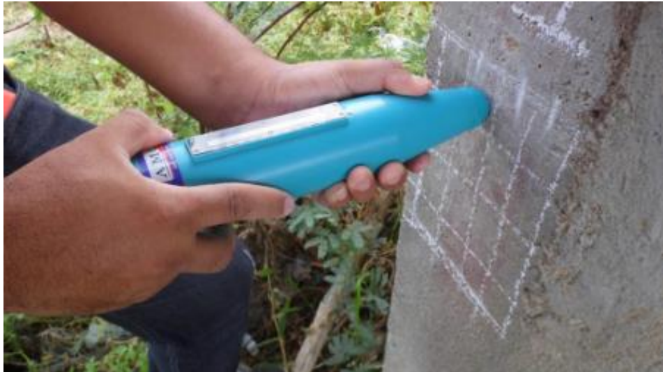
Figura 3 - Esclerômetro de Schmidt em posição de ensaio.
