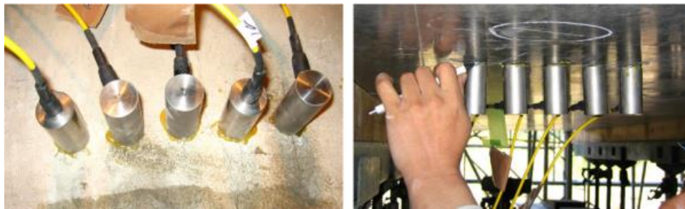
Figura 16 - Aplicação de tomografia ultrassônica em uma viga de concreto armado.
