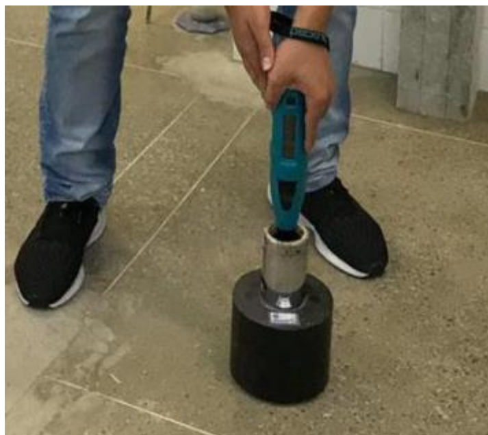
Figura 5 - Calibração do esclerômetro na bigorna.
