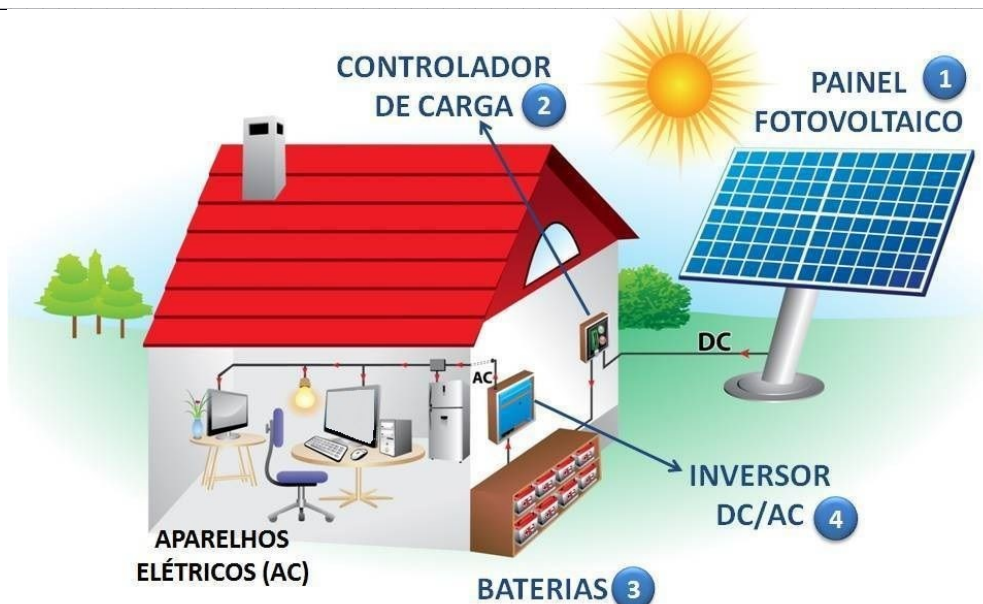
Figura 8: Representação do funcionamento do Sistema Off Grid.
