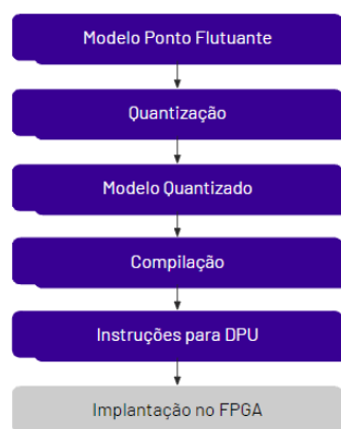
Figura 3. Etapas do Vitis AI para implantação da rede neural em FPGA. Fonte: Autoria própria
