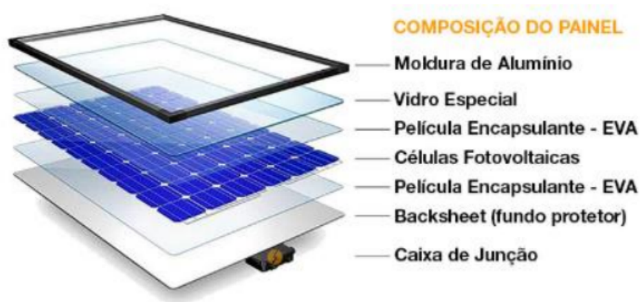
Figura 3 - Representação de módulo fotovoltaico e sua composição.
