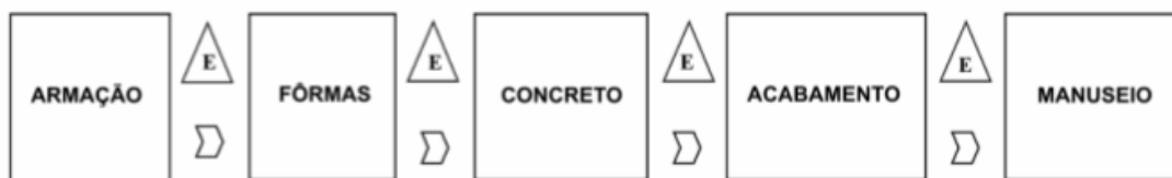
Figura 2 - Etapas da produção de elementos pré-fabricados
