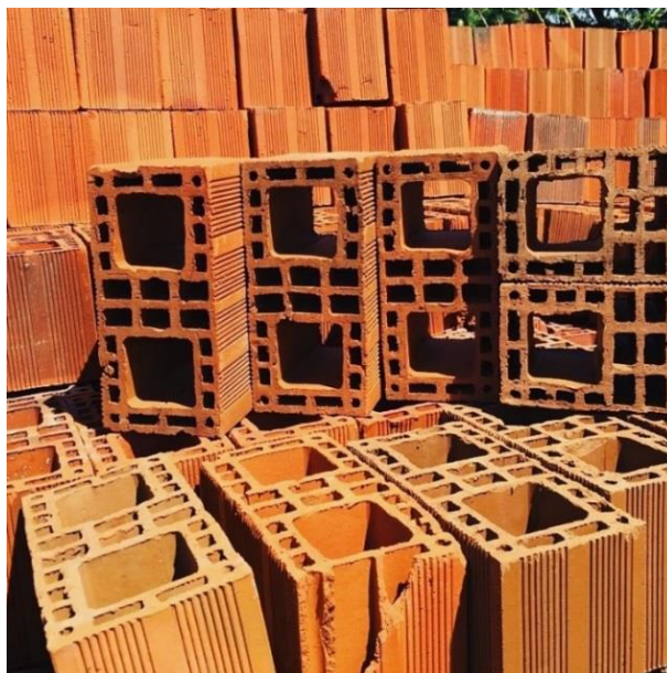
Figura 2.3: Blocos estruturais ou portantes.
