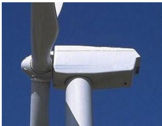
Figura 14 - Nacelle Parte externa
