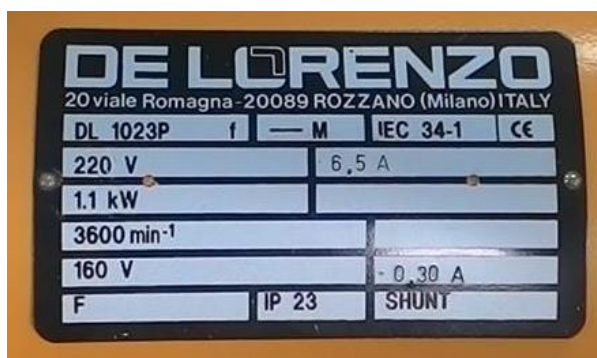
Figura 17- características nominais do motor
