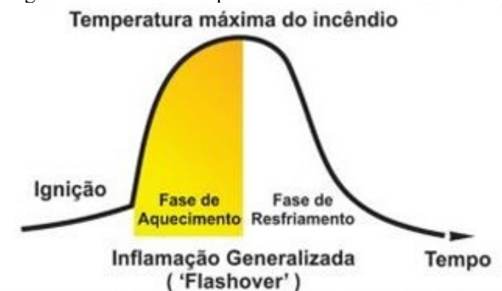
Figura 2 - Curva de temperatura máxima de um incêndio
