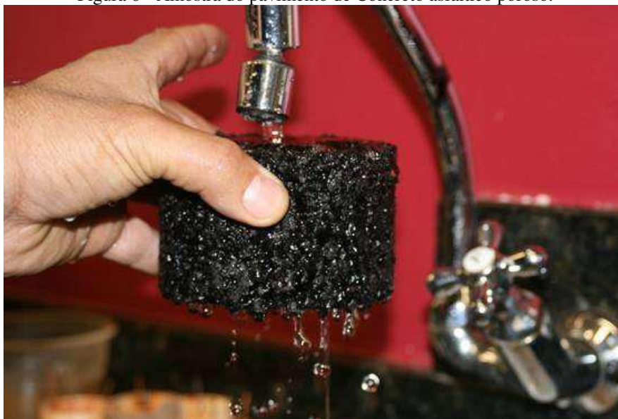
Figura 6 - Amostra do pavimento de Concreto asfáltico poroso.
