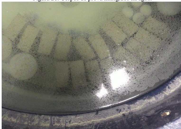
Figura 26: Corpos de prova imergidos na água.
