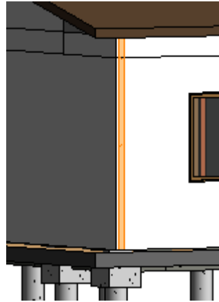
Figura 34: Pilares P2, P3, P4 e P12 respectivamente saindo das paredes
