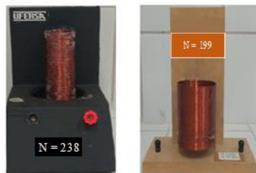
Figura 8: Solenoides desenvolvidos pelos alunos da disciplina de laboratório de eletricidade e magnetismo do CMPF.
