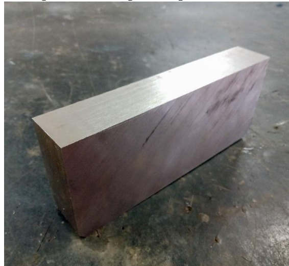
Figura 07 – Chapa metálica após a o processo de corte do tarugo.
