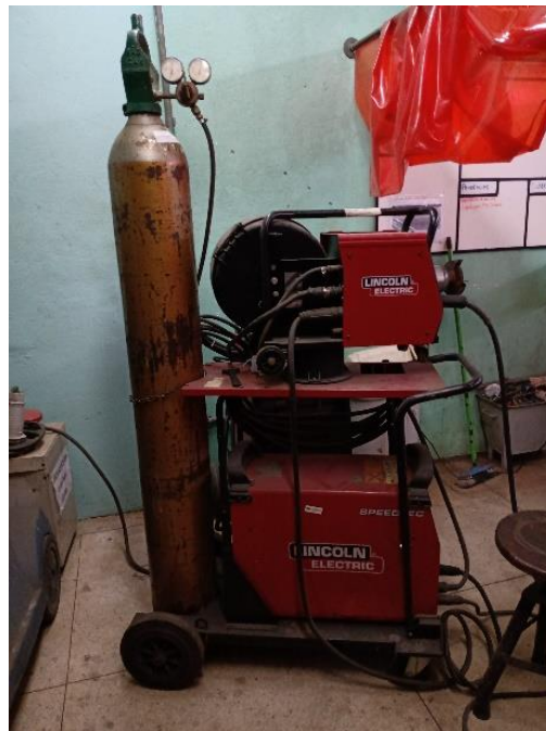
Figura 13 – Equipamento utilizado no processo de soldagem.
