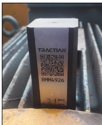
Figura 19 – Sensor parafusado na carcaça do motor
