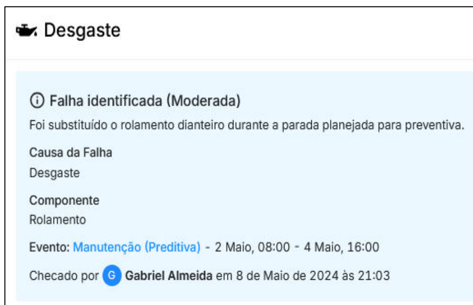
Figura 37 – Desgaste de rolamento identificado pelo sistema e peça substituída durante manutenção planejada
