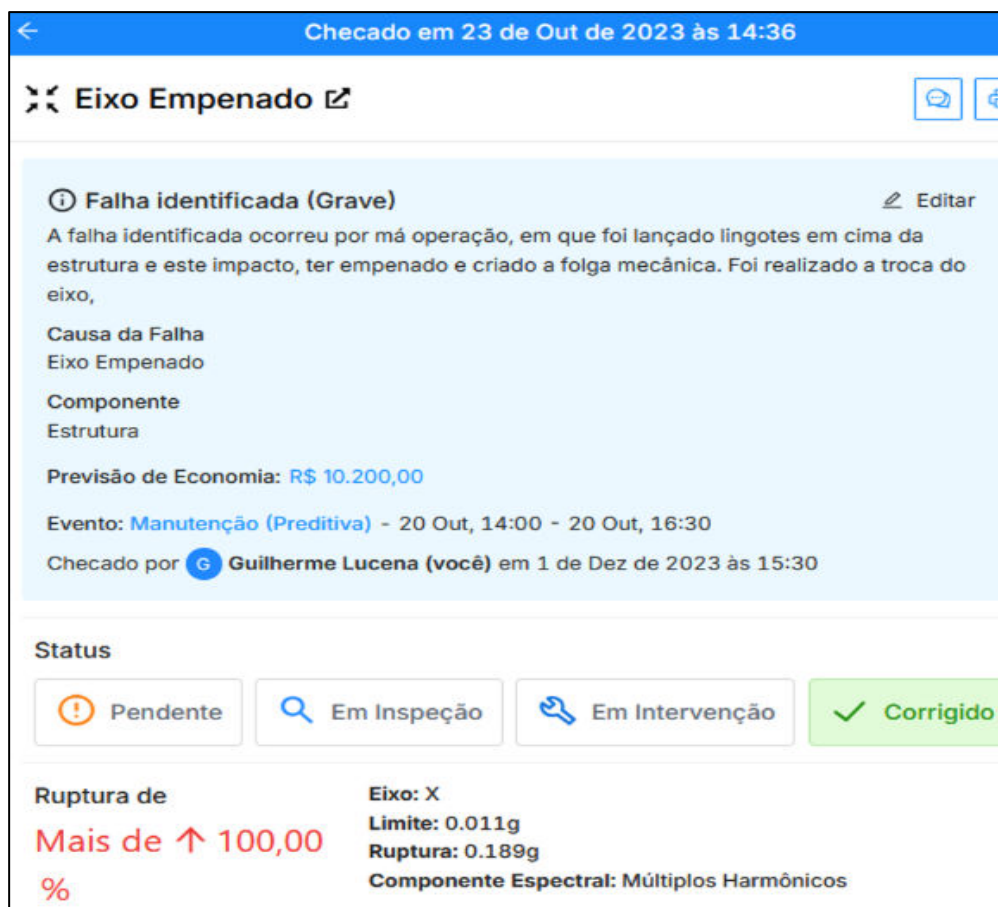
Figura 35 – Falha por erro operacional
