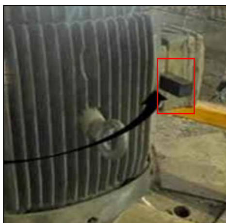
Figura 17 – Sensor posicionado no motor elétrico de um mexedor robusto
