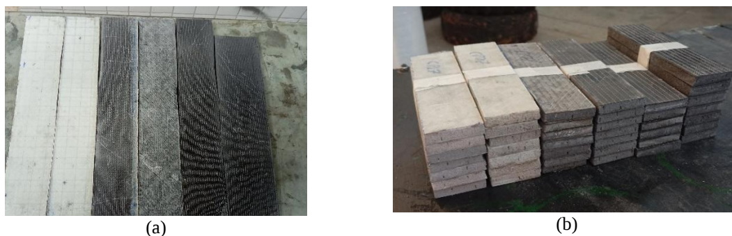
FIGURA 3. Preparação das amostras: (a) Corte destacando as seis configurações; (b) Corpos de prova finalizados.
