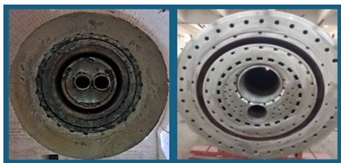
Figura 3: Comparação do queimador antigo com o novo
