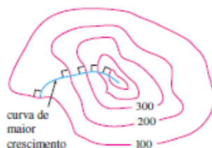
Figura 2.2: Curvas de níveis em tonalidade rosa, e em azul está destacada a curva onde se tem o maior crescimento da função, conforme a mesma se aproxima do centro.
