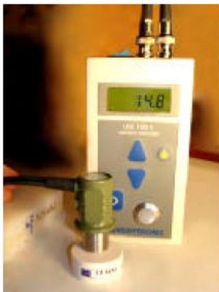
Figura 6 – Medidor de Espessura Digital Ultra-Sônico
