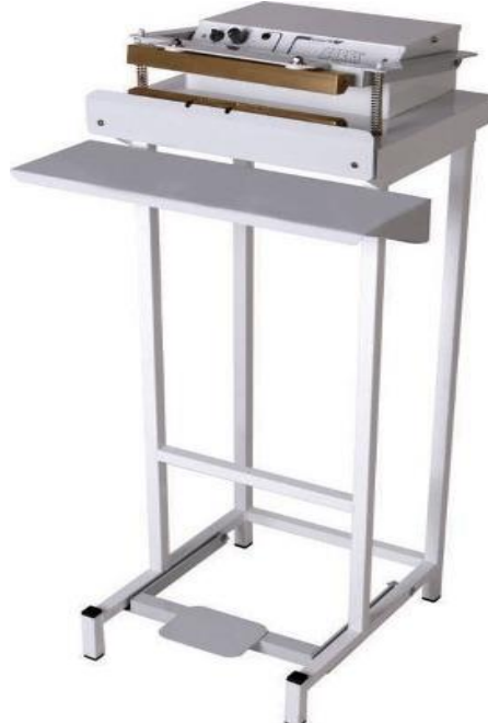
Figura 52. Seladora Datadora para Embalagem de Picolé TCH 200 D Barbi, Seladora de pedal - Solda Recravada Horizontal com Datador.
