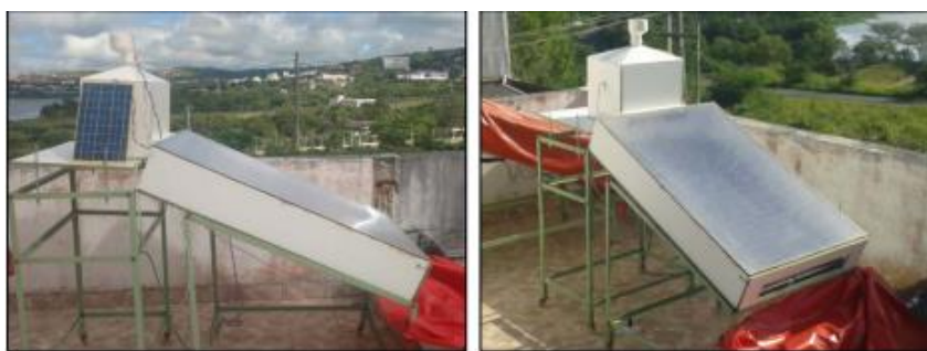
Figura 02: Secador solar de exposição indireta
