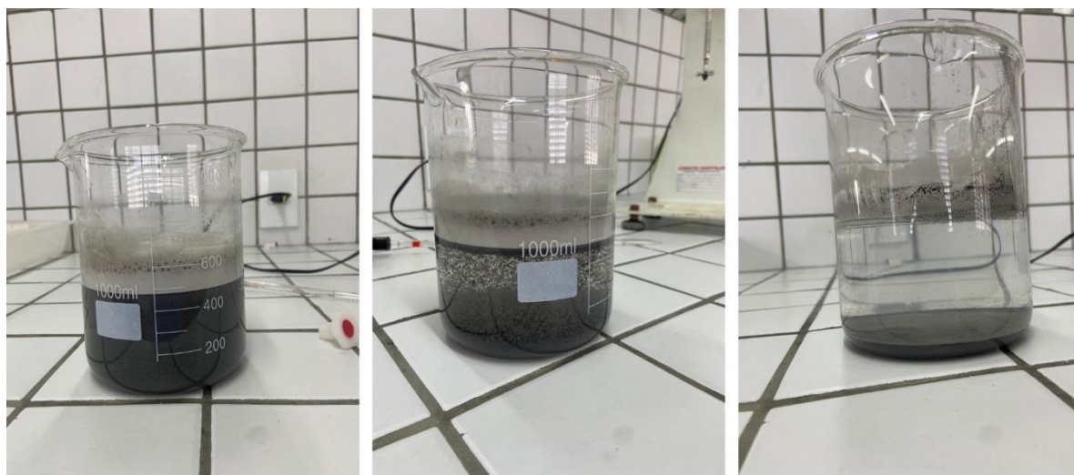
Figura 2. Processo de tratamento convencional.
