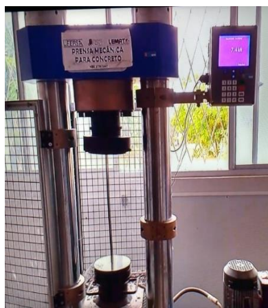
Figura 11: Ensaio com barra biarticulada. (Autoria Própria)
