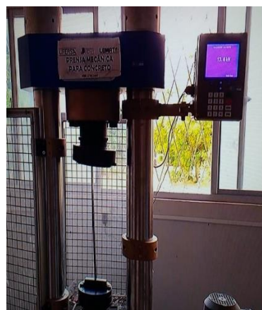
Figura 12: Ensaio com barra engastada em uma extremidade e na outra pino. (Autoria própria)
