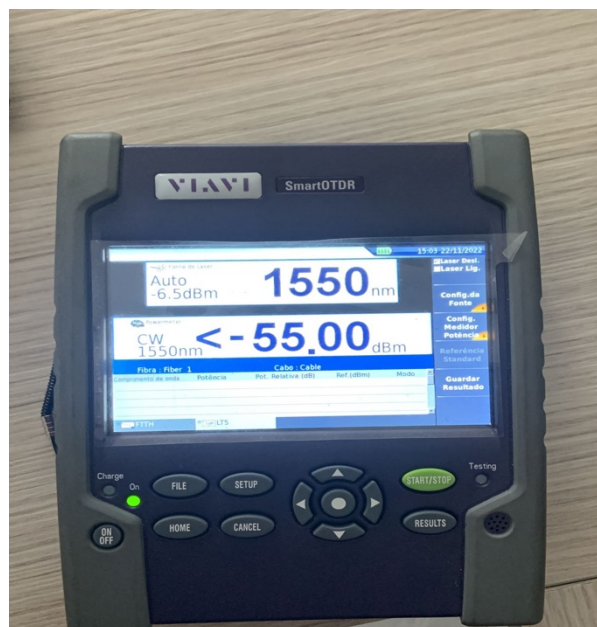
Figura 45 - OTDR utilizado nos testes
