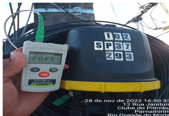
Figura 46 - Power Meter realizando medição em uma CTO
