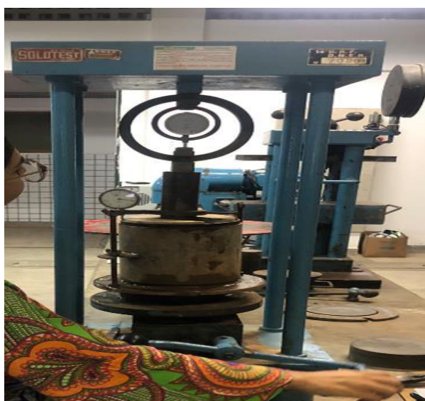
Figura 25 – Leitura da penetração no Solo
