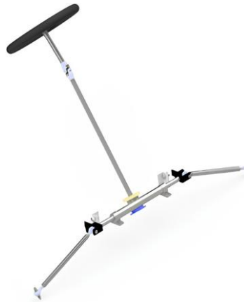
Figura 5 - Sistema de direção mecânica do Severo 2.0.
